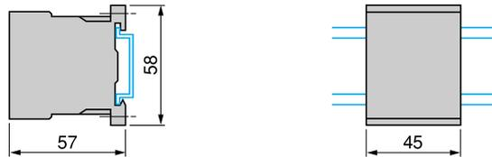
На одной асимметричной рейке DZ5-MB с монтажной платой безвинтового крепления
